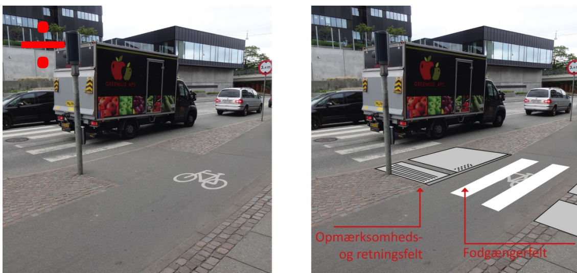
Figur 3.24 Signalreguleret fodgængerfelt fortsætter i en cykelstikrydsning uden fodgængerfelt. Personer der er blinde og svagsynede vil kunne tro de må krydse cykelstien, når lydsignalet giver lyden for "gå". Der mangler desuden de anbefalede taktile felter.
