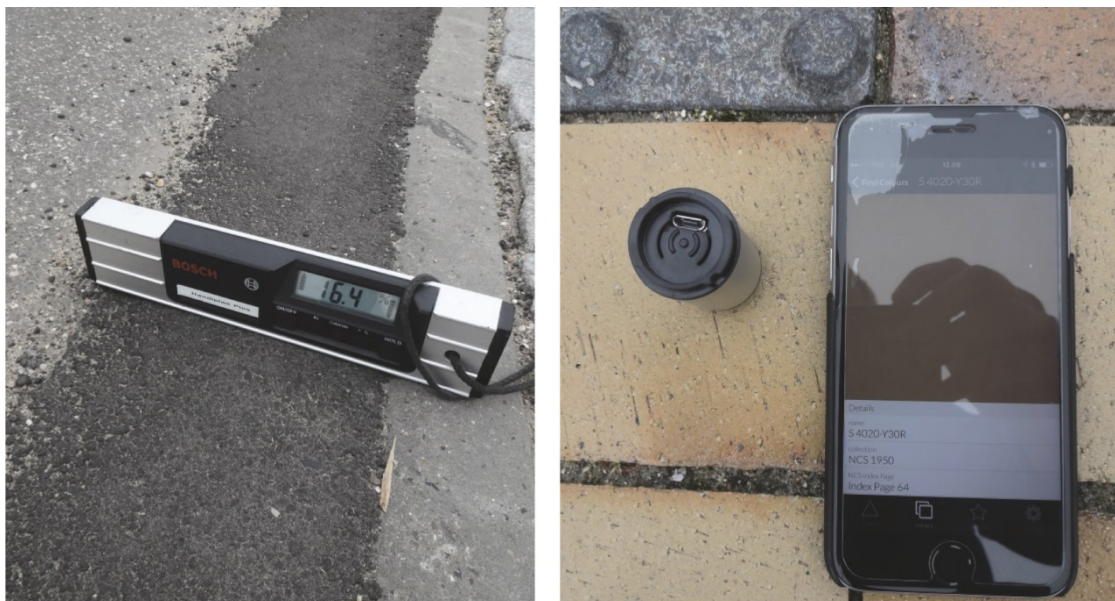
Figur 4.1 Måling af rampehældning (måling her i %, skal omregnes til ‰) og lysrefleksionsværdi på en besigtigelse (fotos Rambøll).
